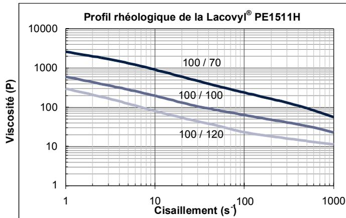
Измерение вязкости в смесях ПВХ 100 phg и пластификатора DINP в соотношении 70, 100 и 120 при помощи ротативного реометра после 2 часов созревания при температуре 23°C.
